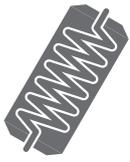
L'absorbeur d'énergie est obligatoirement utilisé dans des situations où l'utilisateur est exposé à un risque de chute. Le longe antichute sert à dissiper l'énergie en cas de chute et à limiter la force de freinage à un niveau non lésionnel.
