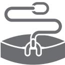
La ceinture de maintien au travail peut être utilisée seule (retenue) ou intégrée à un harnais antichute, (maintien au poste de travail). La longe de maintien au travail permet de relier une ceinture à un point d'ancrage (retenue), ou à une structure en l'entourant, de manière à pouvoir lâcher les mains (maintien au travail).
