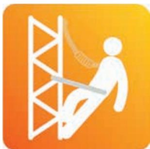
Un système de maintien au poste de travail ne se substitue en aucun cas au système d'arrêt des chutes dont il n'assure pas la fonction et auquel il est absolument nécessaire de l'associer. Avec ce système, l'utilisateur est capable d'intervenir sur des structures nécessitant une position de travail en appui ou en suspension.
